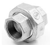
União Conica Assento Ferro NBR 6943 galvanizado BSP Fabricado em conformidade com NBR 6943 ISO 49 / DIN 2950 Extremidades roscadas BSP conforme NBR NM ISO 7.1 Vedação cônica ferro/ferro Temperatura de trabalho 300°C Pressão máxima de serviço 25 bar de -20°C a 120°C
