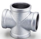
Cruzeta NBR 6943 galvanizado BSP Rebordo reforçado tipo "heavy banded" Fabricado em conformidade com NBR 6943 ISO 49 / DIN 2950 Extremidades roscadas BSP conforme NBR NM ISO 7.1 Temperatura de trabalho 300°C Pressão máxima de serviço 25 bar de -20°C a 120°C
