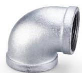
Cotovelo 90° NBR 6943 maleável galvanizado BSP Rebordo reforçado tipo "heavy banded" Fabricado em conformidade com NBR 6943 ISO 49 / DIN 2950 Extremidades roscadas BSP conforme NBR NM ISO 7.1 Temperatura de trabalho 300°C Pressão máxima de serviço 25 bar de -20°C a 120°C
