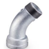
Curva M/F 45° NBR 6943 galvanizado BSP Rebordo reforçado tipo "heavy banded" Fabricado em conformidade com NBR 6943 ISO 49 / DIN 2950 Extremidades roscadas BSP conforme NBR NM ISO 7.1 Temperatura de trabalho 300°C Pressão máxima de serviço 25 bar de -20°C a 120°C
