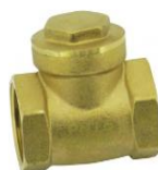
Válvula de retenção horizontal latão Buna-N BSP Corpo em latão forjado e jateado. Extremidades BSP conforme ISO 228/1 fêmea-fêmea Temperatura de trabalho de -10°C a +110°C Pressão máxima de trabalho 16 bar (PN16) Vedação metal/Buna-N
