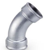
Curva 45° NBR 6943 galvanizado BSP Fabricado em conformidade com NBR 6943 ISO 49 / DIN 2950 Extremidades roscadas BSP conforme NBR NM ISO 7.1 Temperatura de trabalho 300°C Pressão máxima de serviço 25 bar de -20°C a 120°C
