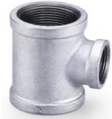
Tê Redução 90° NBR 6943 galvanizado BSP Rebordo reforçado tipo "heavy banded" Fabricado em conformidade com NBR 6943 ISO 49 / DIN 2950 Extremidades roscadas BSP conforme NBR NM ISO 7.1 Temperatura de trabalho 300°C Pressão máxima de serviço 25 bar de -20°C a 120°C
