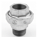
União Assento Bronze MF NBR 6943 galvanizado BSP Fabricado em conformidade com NBR 6943 ISO 49 / DIN 2950 Extremidades roscadas BSP conforme NBR NM ISO 7.1 Vedação cônica ferro/bronze Temperatura de trabalho 300°C Pressão máxima de serviço 25 bar de -20°C a 120°C
