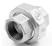
União Assento Bronze NBR 6943 galvanizado BSP Fabricado em conformidade com NBR 6943 ISO 49 / DIN 2950 Extremidades roscadas BSP conforme NBR NM ISO 7.1 Vedação cônica ferro/bronze Temperatura de trabalho 300°C Pressão máxima de serviço 25 bar de -20°C a 120°C
