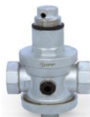
Válvula redutora de pressão pistão BSP Corpo em latão forjado jateado. Extremidades BSP conforme ISO 228/1 fêmea-fêmea Temperatura de trabalho de 0°C a +80°C Pressão máxima 25 bar Setagem de fábrica para 3 bar Regulável de 1 a 6 bar
