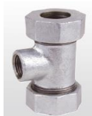
TÊ Dresser galvanizado Corpo Ferro Maleável de Núcleo Preto Roscas do acoplamento ISO 228-1 Rosca vedação ISO 7.1 Anel de vedação em borracha EPDM Anel de compressão em aço carbono Para Água pressão máxima de serviço 16 bar a 80°C Para Ar pressão máxima de serviço 10 bar a 80°C
