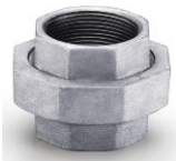
União Assento Plano NBR 6943 galvanizado BSP Fabricado em conformidade com NBR 6943 ISO 49 / DIN 2950 Extremidades roscadas BSP conforme NBR NM ISO 7.1 Vedação plana com NBR. Temperatura de trabalho 300°C Pressão máxima de serviço 25 bar de -20°C a 120°C
