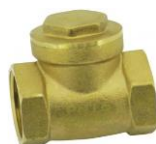
Válvula de retenção horizontal latão Metal/Metal BSP Corpo em latão forjado e jateado. Extremidades BSP conforme ISO 228/1 fêmea-fêmea Temperatura de trabalho de -10°C a +110°C Pressão máxima de trabalho 16 bar (PN16) Vedação metal/metal
