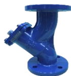
FILTRO Y FLANGEADO 125 LIBRAS Corpo em ferro nodular Filtro em aço inoxidável SS304 Face a Face conforme DIN 3202 F1 Extremidades flangeadas conforme ANSI B16.1 125 lbs Pressão máxima de trabalho 1,6 Mpa Temperatura de trabalho de -10°C a 80°C
