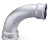
Curva 90° NBR 6943 galvanizado BSP Fabricado em conformidade com NBR 6943 ISO 49 / DIN 2950 Extremidades roscadas BSP conforme NBR NM ISO 7.1 Temperatura de trabalho 300°C Pressão máxima de serviço 25 bar de -20°C a 120°C
