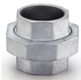
União Assento Bronze NBR 6943 galvanizado BSP Fabricado em conformidade com NBR 6943 ISO 49 / DIN 2950 Extremidades roscadas BSP conforme NBR NM ISO 7.1 Vedação cônica ferro/bronze Temperatura de trabalho 300°C Pressão máxima de serviço 25 bar de -20°C a 120°C
