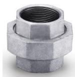
União Assento Conico Ferro NBR 6943 galvanizado BSP Fabricado em conformidade com NBR 6943 ISO 49 / DIN 2950 Extremidades roscadas BSP conforme NBR NM ISO 7.1 Vedação cônica ferro/ferro Temperatura de trabalho 300°C Pressão máxima de serviço 25 bar de -20°C a 120°C
