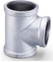
Tê 90° de ferro fundido maleável galvanizado BSP Rebordo reforçado tipo "heavy banded" Fabricado em conformidade com NBR 6943 ISO 49 / DIN 2950 Extremidades roscadas BSP conforme NBR NM ISO 7.1 Temperatura de trabalho 300°C Pressão máxima de serviço 25 bar de -20°C a 120°C
