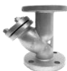
FILTRO Y FLANGEADO 150 LIBRAS Corpo em WCB (aço carbono) Filtro em aço inoxidável SS304 Extremidades flangeadas conforme ANSI B16.1 150 lbs Pressão Nominal 150 lbs Temperatura máxima de trabalho 350°C
